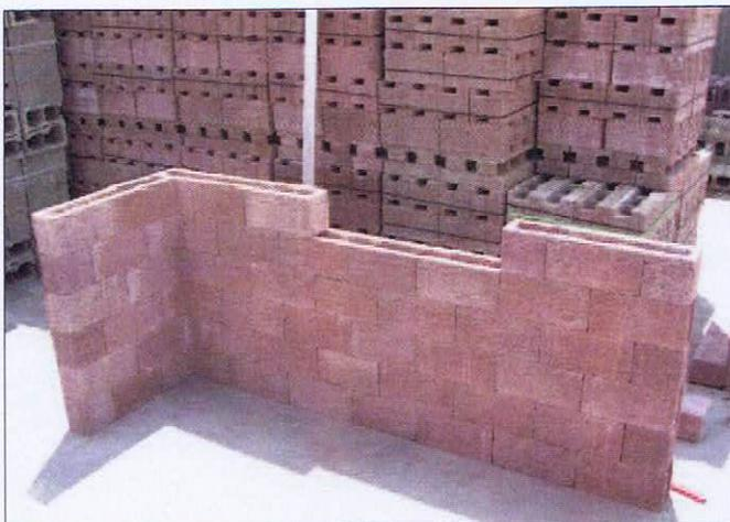
Holzspan-Mantelsteine gemäß ÖNORM EN 15498 sind Schalungssteine aus Holzspanbeton, die aus Längswandungen bestehen, die mit Querstegen verbunden sind. Gegebenenfalls ist ein Zusatz-Dämmstoff (EPS, Kork, udgl.) integriert. Sonderformen von Holzspan-Mantelsteinen dienen für die fachgerechte Ausführung von Konstruktionsdetails, wie Ecken, Gewände, Deckenroste, usw.
