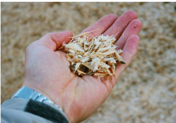
Holzspäne für die Herstellung von Holzspanbeton
