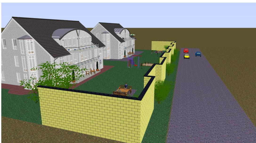
Durch Eckausbildungen der Durisol- Lärmschutzwände ergeben sich neue Gestaltungsmöglichkeiten und höhere Steifigkeiten des Wandaufbaues. Diese Bauweise ermöglicht auch einen höheren Wandaufbau oder eine geringere Fundamentbreite.
