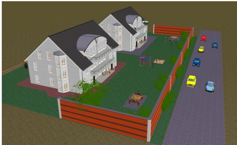
Wände aus z.B. Durisol- Lärmschutzsteinen DSi 30/13 N erreichen bis zu **17 dB Schallabsorption** und **31 dB Schalldämmung**. Lärmschutzwände, welche schallabsorbierende Eigenschaften von mehr als 11 dB durch Prüfung nachweisen können, werden bereits als "hochabsorbierende Lärmschutzwände" geführt. Eine Schallreduzierung von 10 dB empfindet der Mensch als eine Halbierung des Lärmaufkommens. Durisol- Lärmschutzwände wurden mit bis zu 17 dB Schallabsorption geprüft!
