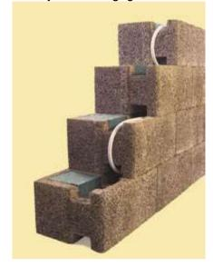
Die in dem Betonkern der Außenwand eingespeiste Sonnenenergie ermöglicht ein gewünschtes Temperaturniveau von 20° Celsius, so dass die Transmissionsverluste des Gebäudes zusätzlich verringert werden und temporär auf den theoretischen U-Wert = 0 sinken, bzw. es werden Wärmegewinne aus der Wand in Richtumg Raum fließen.
