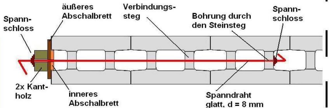
Das hier dargestellte Wandbausystem einer Durisol- Lärmschutzwand ist als ein Ausführungsbeispiel anzusehen. Die Anordnung und Bemessung der Baustahlzulagen ist dem statischen Tragkonzept zu entnehmen.
