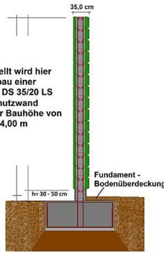
Dargestellt wird hier der Aufbau einer Durisol- DS 35/20 LS Lärmschutzwand mit einer Bauhöhe von z.B.  $h = 4,00$  m
