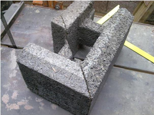
Die so verklebten Schrägschnitte sind nach dem Aushärten in der Lage dem später ankommenden Betondruck standzuhalten.
