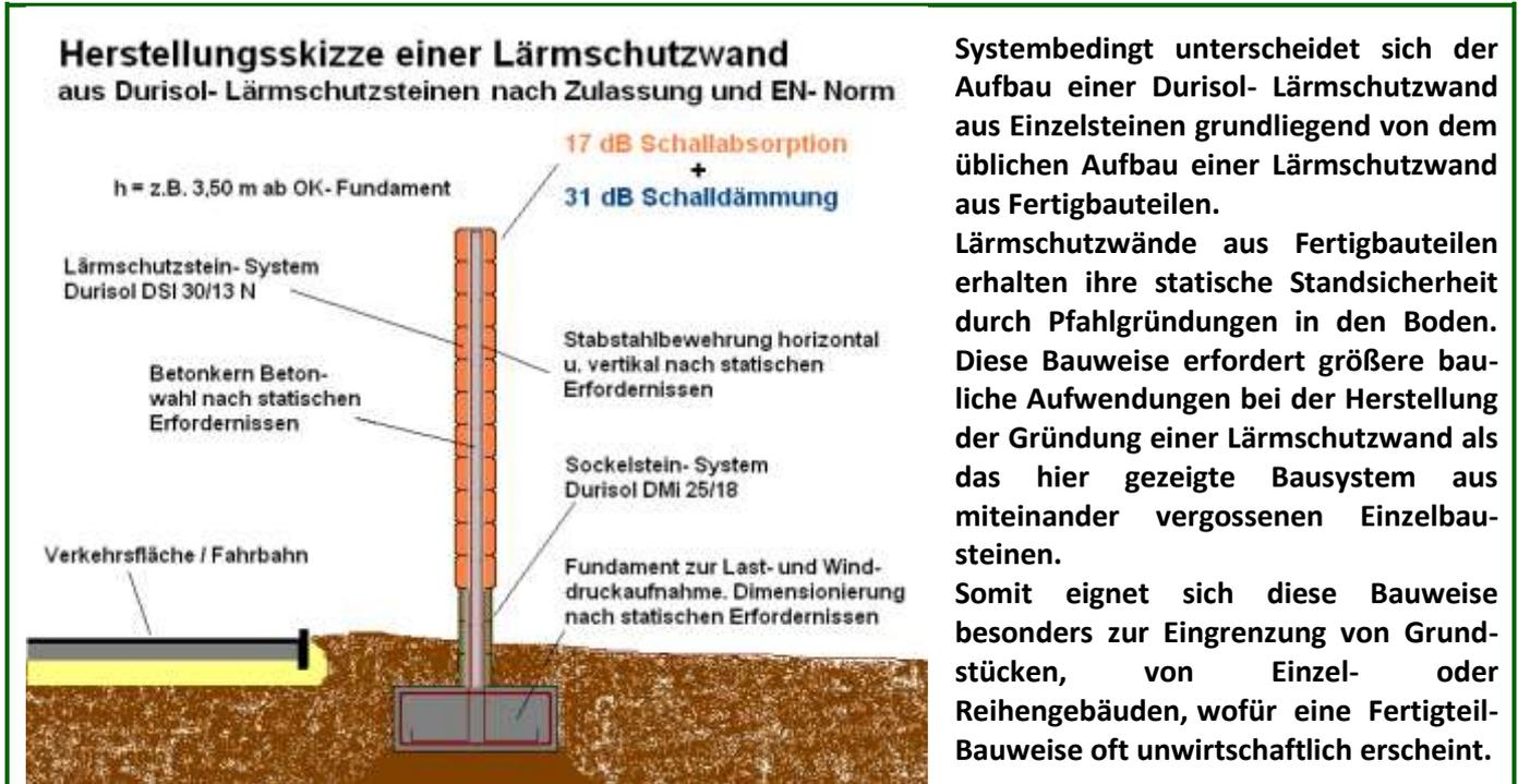
Systembedingt unterscheidet sich der Aufbau einer Durisol- Lärmschutzwand aus Einzelsteinen grundlegend von dem üblichen Aufbau einer Lärmschutzwand aus Fertigbauteilen.
